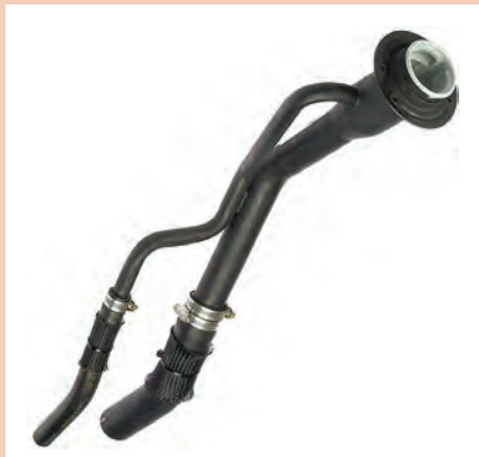
شکل ۳۷- لوله فلزی ورودی و مجرای کناری
