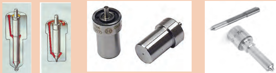
شکل ۴۸- نازل سوراخ دار و زبانه دار
