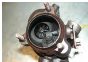
شکل ۸۳- نشستی روغن در توربوشارژر
