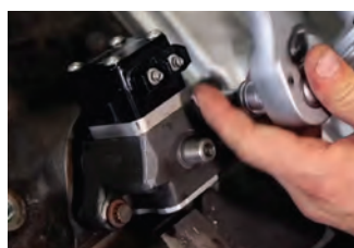
شکل ۶۶- برخی از مراحل سرویس و تعمیر یک نوع پمپ واحد
