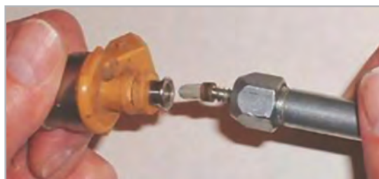
شکل ۷۹- تعویض فیلتر انژکتور
