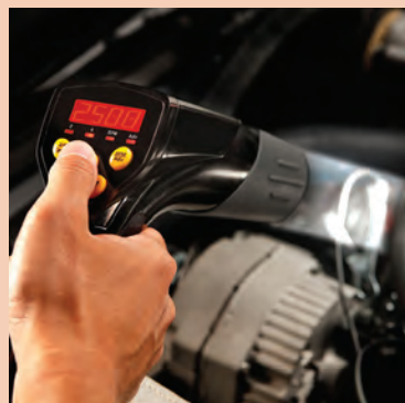
شکل ۲۱- روش کاربری چراغ تایمینگ
