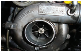
شکل ۸۳- نشستی روغن در توربوشارژر
