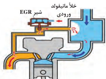
شکل ۱۹- مسیر عبور گازهای خروجی خلأی
