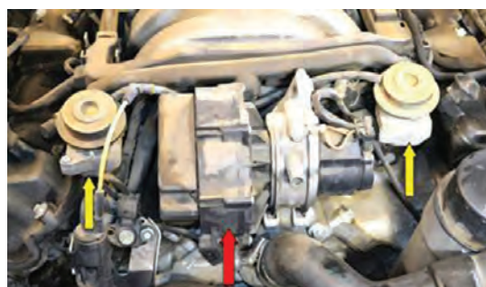
شکل ۵۱- بررسی‌های اتصالات مکانیکی، الکتریکی و خلأئی پمپ دمنده
