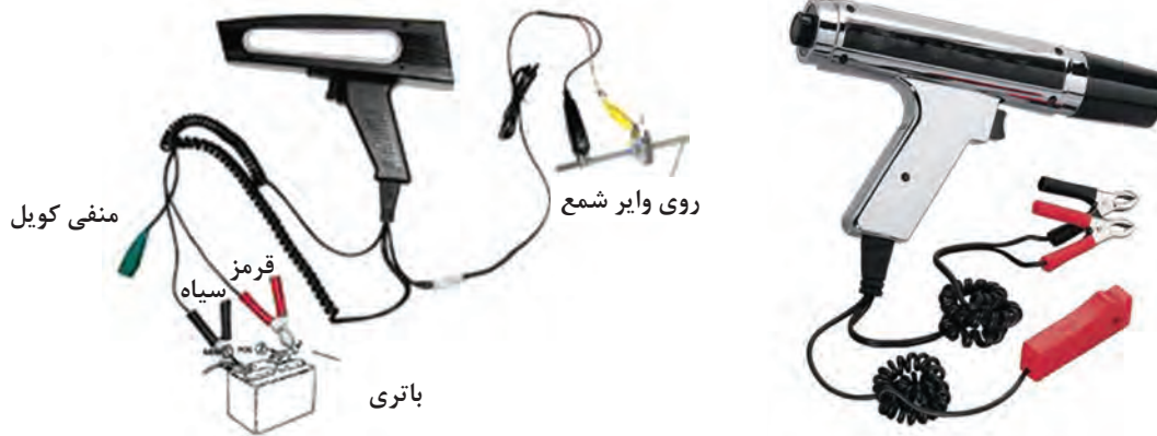
شکل ۲۰- نوعی چراغ تایمینگ و روش اتصال آن به سیم‌کشی خودرو
