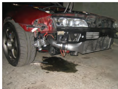
شکل ۴۹- یک نوع نشتی سیستم سوخت‌رسانی
