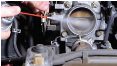
شکل ۸۱- سرویس دریچه گاز
