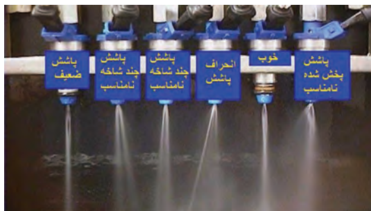
شکل ۷۷- انواع احتمالی پاشش سوخت در انژکتور
