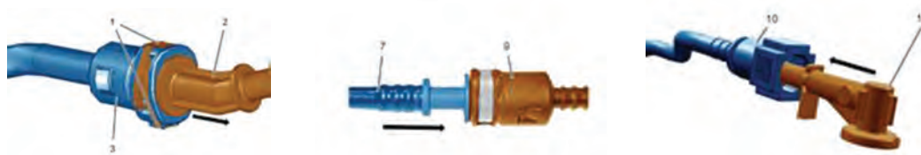
شکل ۷۳- نمونه‌ای از اتصالات سریع در مجموعه شیلنگ‌های سوخت
