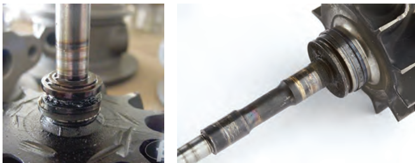
شکل ۸۵- خرابی یاتاقان‌ها و محور توربوشارژر
