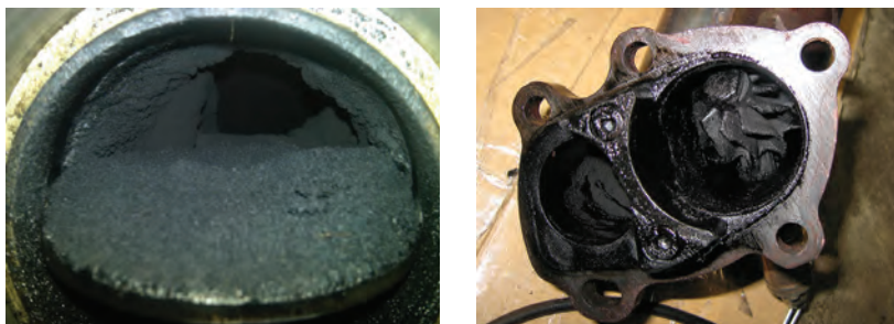
شکل ۸۴- رسوب کربن در ورودی و خروجی توربوشارژر
