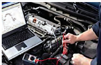
شکل ۴۷- برخی از آزمایش‌های مربوط به مجموعه EGR
