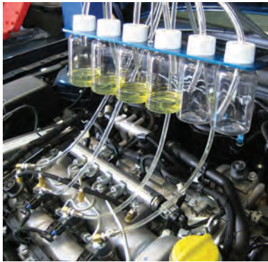
شکل ۵۵- تست اندازه‌گیری مقدار سوخت برگشتی انژکتورها
