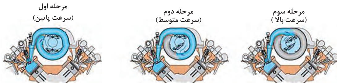
شکل ۴۲- عملکرد سیستم TUMBLE
