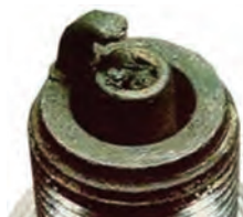
شکل ۳- آسیب به شمع بر اثر خودسوزی
