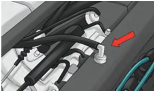
شکل ۱۱- سیستم کنترل آلاینده‌گی محفظه میل لنگ
