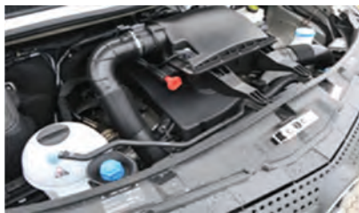
شکل ۹۲- محل‌های قرارگیری در مخزن مایع‌آگزوز دیزل
