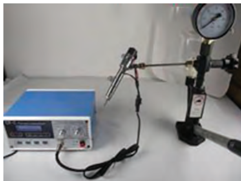
شکل ۸۰- دو نوع دستگاه تست انژکتور
