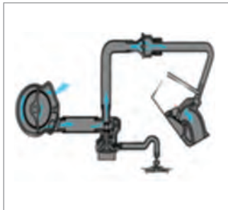
پمپ تزریق ثانویه اسماگ
