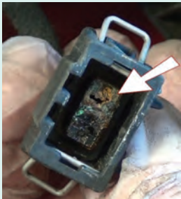
شکل ۶۲- یک نمونه سوکت معیوب
