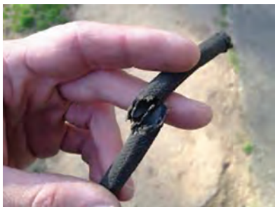
شکل ۴۹- یک نوع نشتی سیستم سوخت‌رسانی
