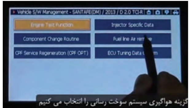
۵- کلیک بر روی گزینه هواگیری
