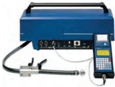
شکل ۵۹- دستگاه تست کدري دود خودروهای ديزلی
