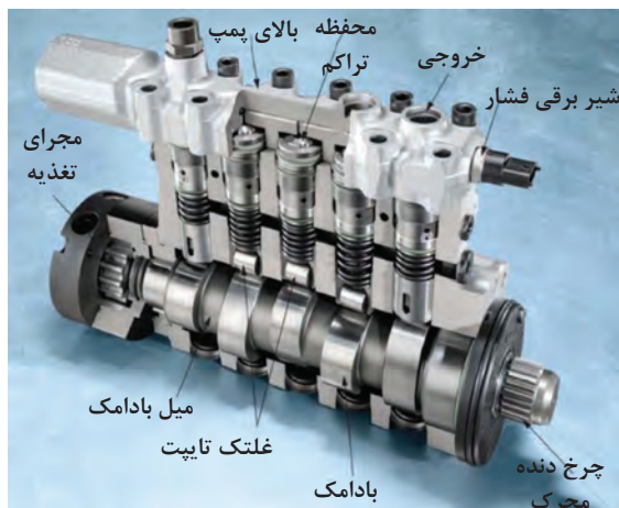
شکل ۲- یک نمونه پمپ انژکتور ردیفی
