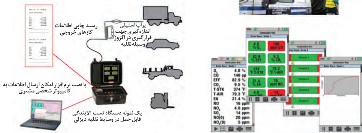
شکل ۷۹- یک نمونه دستگاه تست آلاینده‌ها در وسایط نقلیه دیزلی
