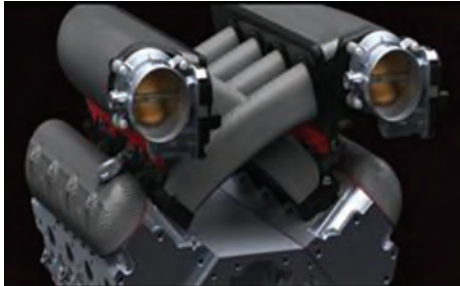
شکل ۳۷- دو نمونه مانیفولد متغیر هوای ورودی
