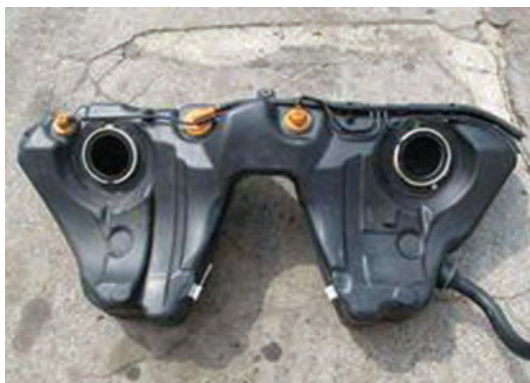
شکل ۷- مخزن سوخت با سوپاپ واژگونی
