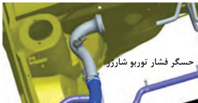
شکل ۳۲- موقعیت حسگر فشار توربو شارژر
