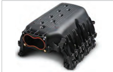
شکل ۳۷- دو نمونه مانیفولد متغیر هوای ورودی
